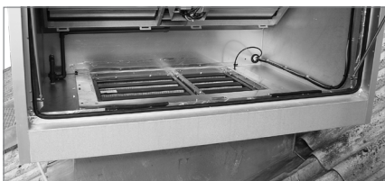
Fig. 33: Filtre d'air extrait installé dans l'appareil
