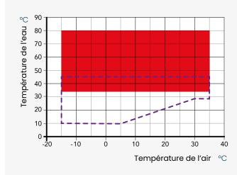
Mode chauffage - Sortie d'eau
