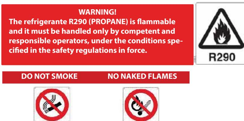
Le réfrigérant utilisé dans les unités est Propane (R290). Sur la base de la Directive 2014/68/EU (ci-après : PED), cette substance est considérée un Gaz (PED, art. 13) du Groupe 1 comprenant les fluides dangereux (extrêmement inflammables).
